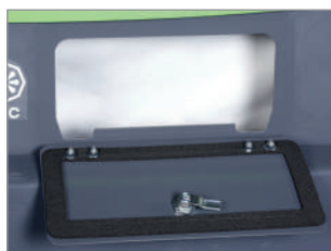
REGISTRO CONEXIÓN DE MANGUERA DE ASPIRACIÓN OPCIONAL
