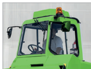
CABINA CON AIRE ACONDICIONADO
